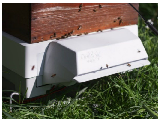
Рис. 2. Роботизированный вход в улей системы Onibi [6]
