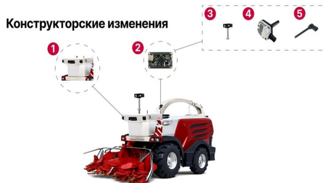
Рис. 1. Общая визуализация беспилотного КУК: 1 — СВК; 2 — STM32; 3 — камера; 4 — датчик уровня охлаждающей жидкости; 5 — датчик уровня масла
