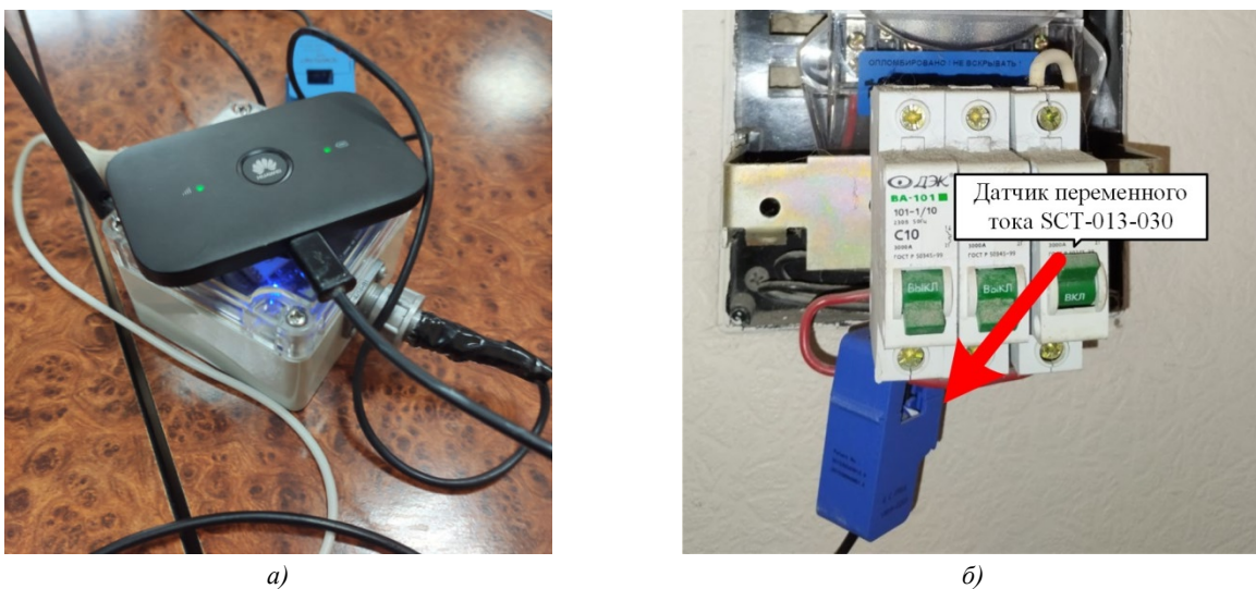
Рис. 1. Система мониторинга работы электрооборудования в помещении:
