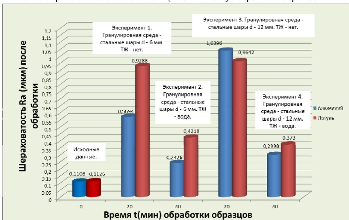
Рис. 3. Гистограмма, иллюстрирующая шероховатость поверхности образцов после достижения времени образования перенаклепа при ЦРОУО
