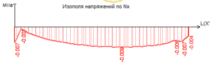
Рис. 7. Эпюра напряжений \sigma_x при z = 3.2 м (в заземлении), полученная в ПК ЛИРА
