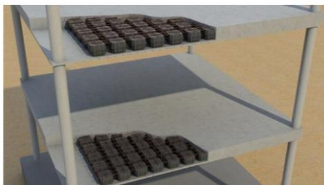
Рис. 2. Несъемная опалубка для перекрытий New Nautilus
