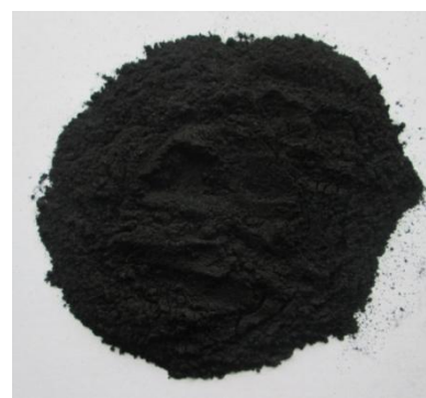
Рис. 3. Углеродный сорбент из скорлупы ореха анакарда, фракция 0,16 мм
