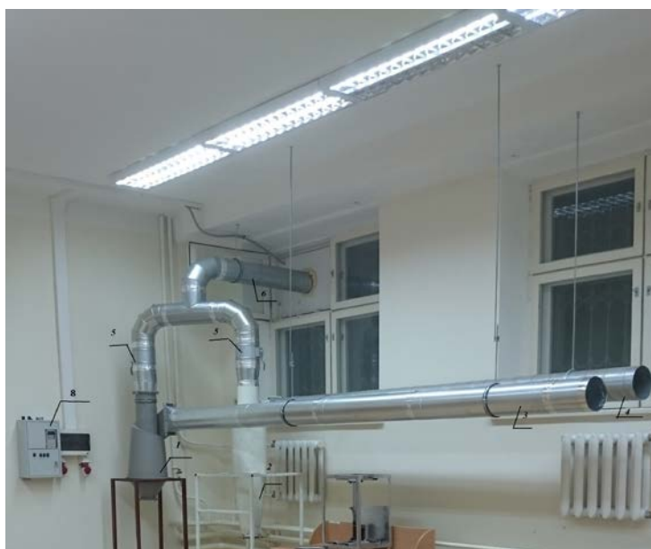
Рис. 1. Экспериментальная установка: 1 — аппарат «Циклон ЦН15у-300», 2 — аппарат «ЦОК-200-300», 3 — входной патрубок «Циклон ЦН-15у-300», 4 — входной патрубок «ЦОК», 5 — закрываемая перегородка, 6 — выходной патрубок, 7 — радиальный вентилятор, 8 — электронный блок управления вентилятором
