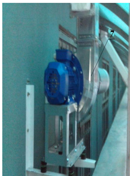
Рис. 1. Экспериментальная установка: 1 — аппарат «Циклон ЦН15у-300», 2 — аппарат «ЦОК-200-300», 3 — входной патрубок «Циклон ЦН-15у-300», 4 — входной патрубок «ЦОК», 5 — закрываемая перегородка, 6 — выходной патрубок, 7 — радиальный вентилятор, 8 — электронный блок управления вентилятором
