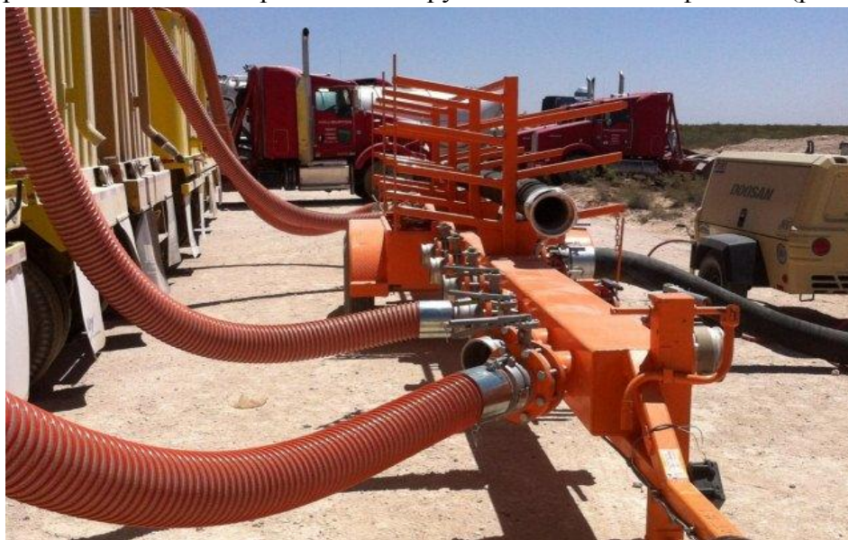
Рис. 6. Блок манифольдов, смонтированный на полуприцепе безрамного типа
