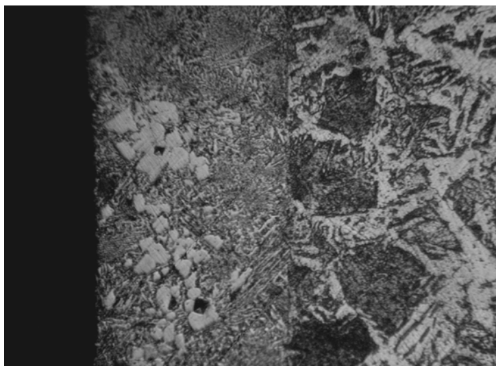
Рис. 3. Боридный слой на стали 20 после борирования из обмазки, содержащей аморфный бор в микродуговом режиме, \times 300
