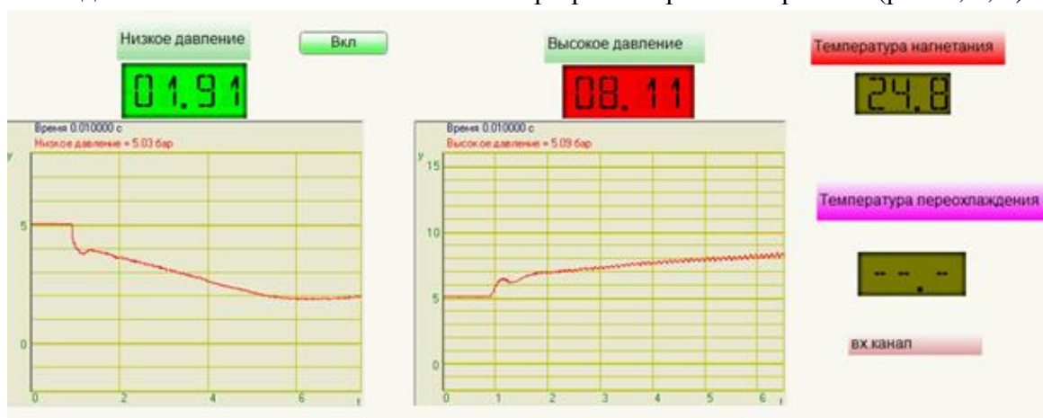
Рис. 2. Запуск автомобильного компрессора кондиционера, работающего в тяжелых условиях эксплуатации
