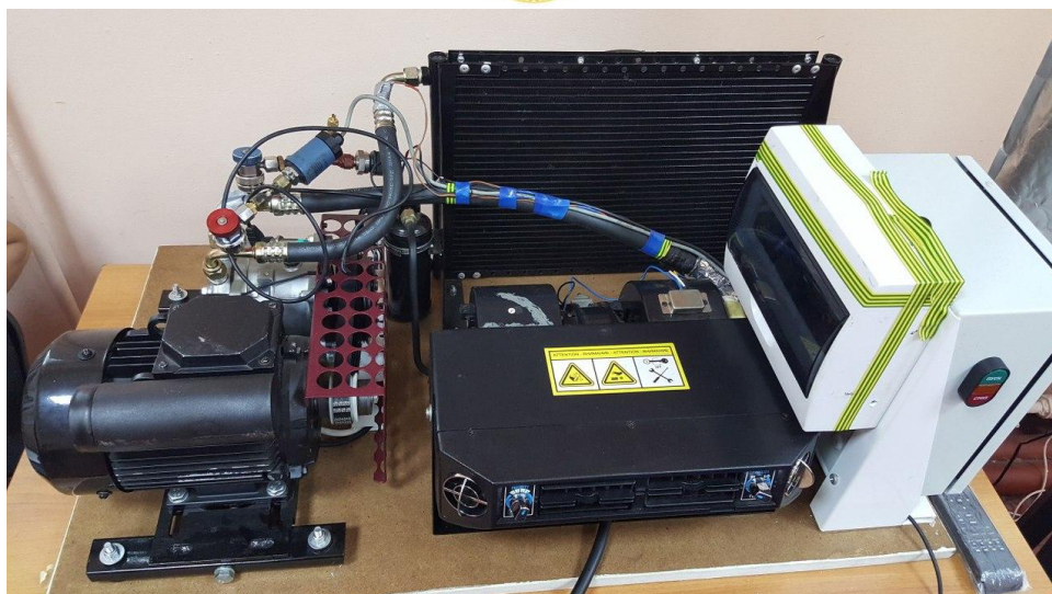
Рис. 1. Стенд-тренажёр по исследованию основных термодинамических параметров автомобильного кондиционера
