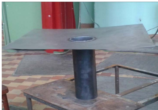
Рис. 2. Соединение труба-лист после сварки
